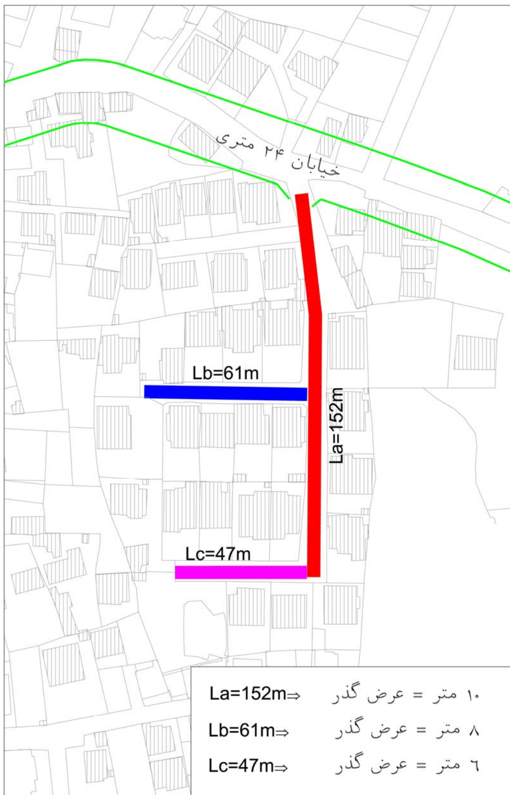
شکل شماره ۱-۵۱ نحوه تعیین طول کوچه بن بست ( بافت ساخته شده )
